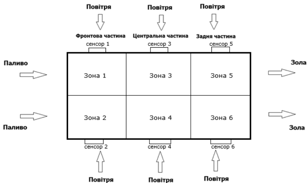
Рис. 2. Схематичне зображення топки, що поділена на зони (вид зверху, на рухому колосникову решітку)
